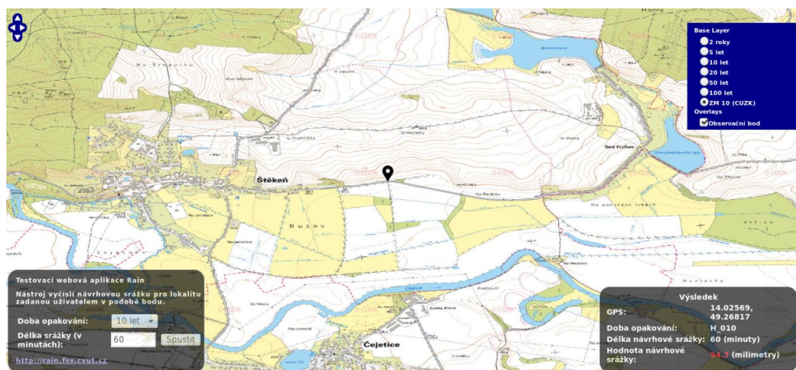
Obr. 1 Ukázka výpočtu úhrnu návrhové srážky pro zvolený bod, dobu opakování a délku srážky. Výsledek je zobrazen v dolní pravé části mapového okna.
