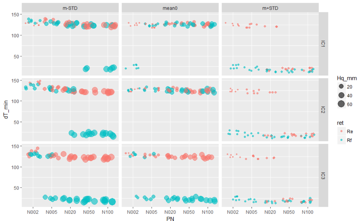
Obrázek 33: Doby zpoždění kulminací (v minutách) na povodí 3-Chouzavé v odezvě na srážku typu C, podle úrovně propustnosti půdy a předchozího nasycení. Barevně varianty dostupného prostoru pro retenci, velikost bodu ukazuje na velikost odtokové výšky.
