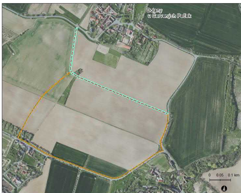
Obrázek 4: Uvažovaný odváděcí příkop nad zástavbou Dolan (červeně – čárkovaně) s vyznačenou sběrnou plochou (oranžová)
